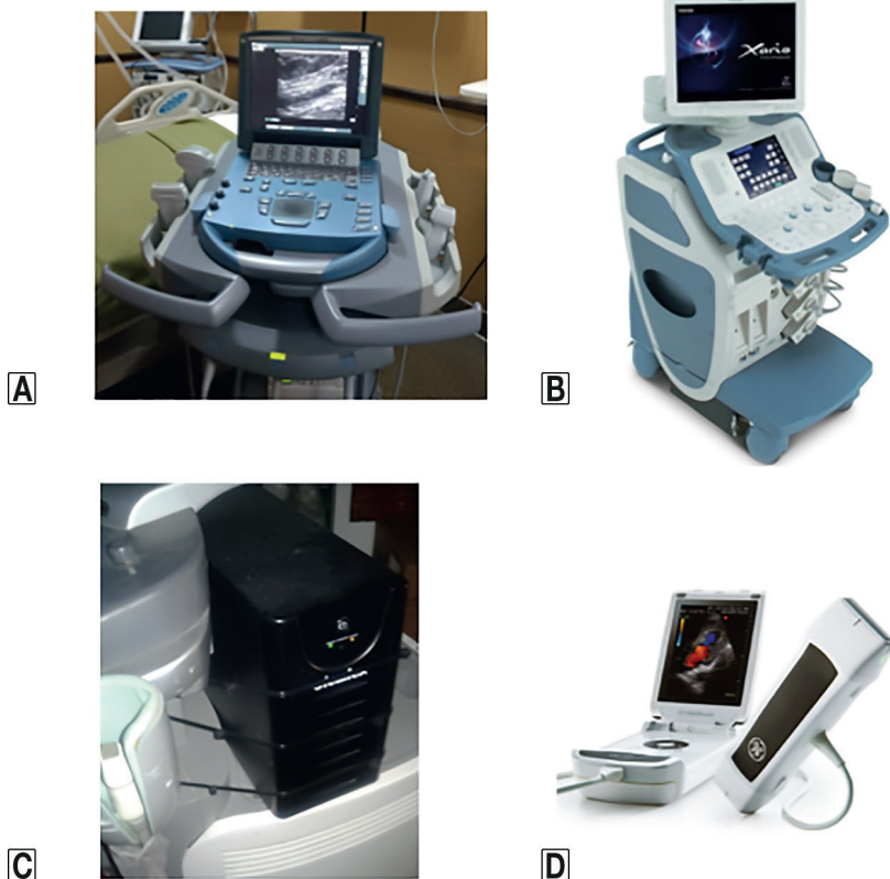
Figura 1-9 A) Ecógrafo portátil (Sonosite Micromaxx®, en su carro rodante). B) Ecógrafo full (plataforma, Toshiba Xario®). C) Uso de un sistema de alimentación ininterrumpida (UPS), instalado en la caja del ecógrafo, con el objeto de brindarle autonomía. D) Ecógrafo hand-held o de bolsillo (General Electric Vscan dual probe®).
