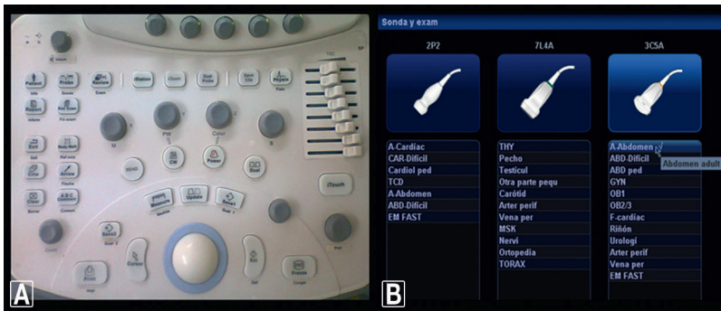
Figura 1-17 A) Panel de botones y comandos de un ecógrafo. B) Elección del transductor y del preset para cada uno de ellos. 2P2: transductor sectorial; 7L4A: transductor lineal; 3C5A: transductor convexo.
