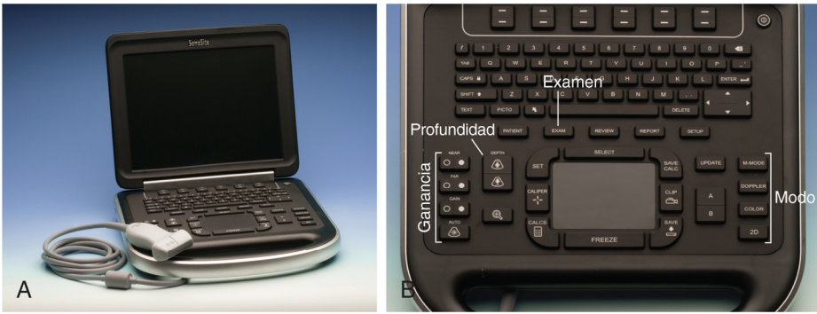
Figura 5.1 Teclado del ecógrafo. Se muestran un típico ecógrafo portátil (A) y un teclado (B), resaltando los controles principales.
