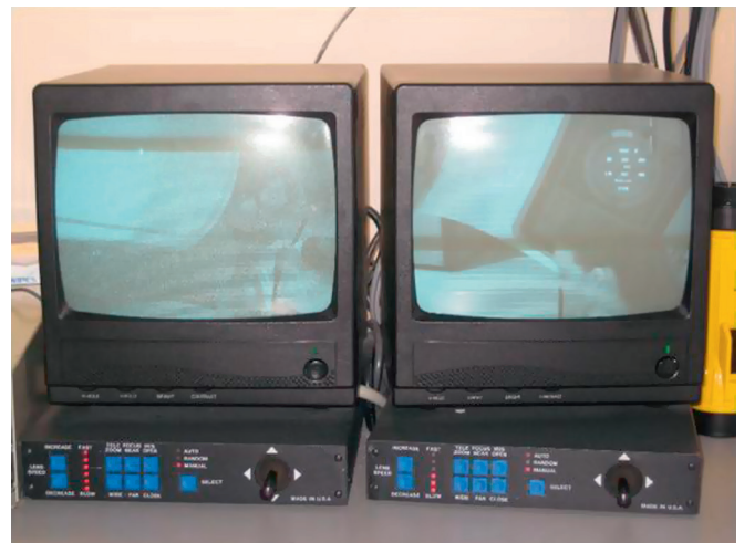
Figura 8.1 Circuito cerrado de televisión en la sala de radiología oncológica para permitir el monitoreo a distancia del paciente.
